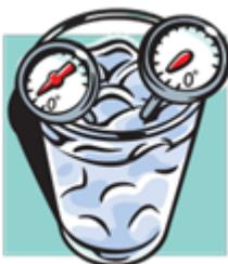
2. Погрузите щуп термометра в смесь, убедившись, что он не касается стенок или дна. Подождите, пока стрелка не перестанет двигаться, чтобы увидеть, какую температуру она показывает. Если температура не 0 °C (32 °F), термометр необходимо отрегулировать.
