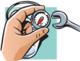
3. Si su termómetro tiene una tuerca de calibración, use una llave pequeña para girarla hasta que la temperatura marque  $0^{\circ}\text{C}$  ( $32^{\circ}\text{F}$ ). Mantenga la sonda en el agua helada para asegurarse de que la temperatura sea precisa.
